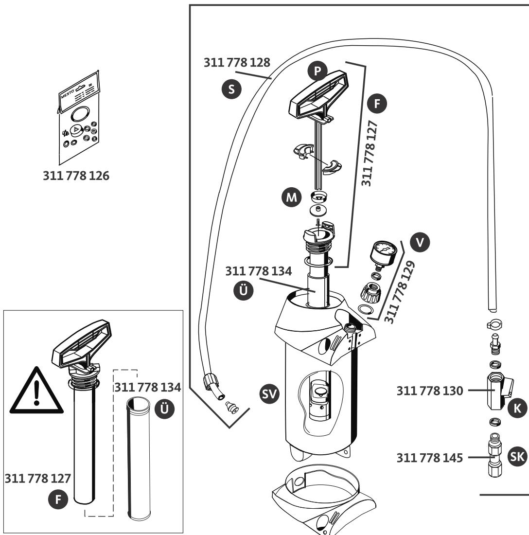
Die Saugluftpumpe 311 778 127 nur zusammen mit dem Messing-Pumpenüberzugrohr 311 778 134 verwenden.
